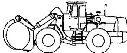
Esempio di caricatore a ruote con pala
