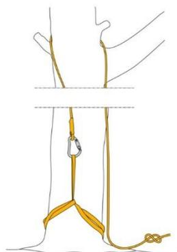
Fig. 6 - Ancoraggio della fune alla base dell'albero
