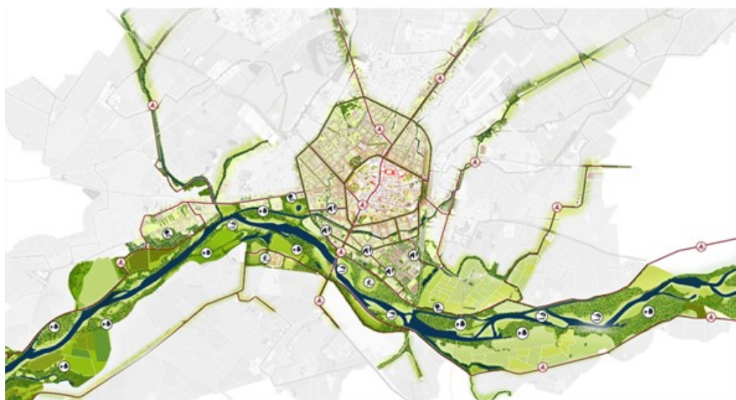
Figura 6 – Scenario di valorizzazione del fiume Sesia (linea blu) con la rinaturalizzazione delle sue sponde (in verde), dotazioni per lo sport e il tempo libero e reti per la mobilità dolce
